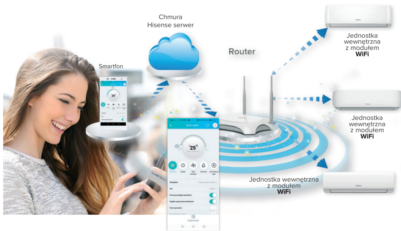
Schemat sterowania za pośrednictwem WiFi
